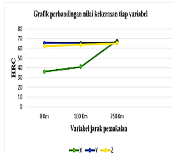
Gambar 19. Grafik perbandingan nilai pengujian kekerasan rockwell tiap variabel
