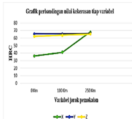
Gambar 19. Grafik perbandingan nilai pengujian kekerasan rockwell tiap variabel
