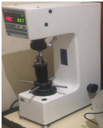
Gambar 15. Proses pengujian kekerasan rockwell
