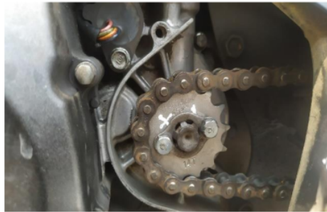
Gambar 7. Sprocket yang telah terpasang
