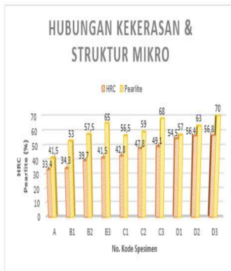
Gambar 12. Diagram Hubungan Variasi Waktu Tahan dan Media Pendingin Terhadap Kekerasan dan Struktur Mikro
