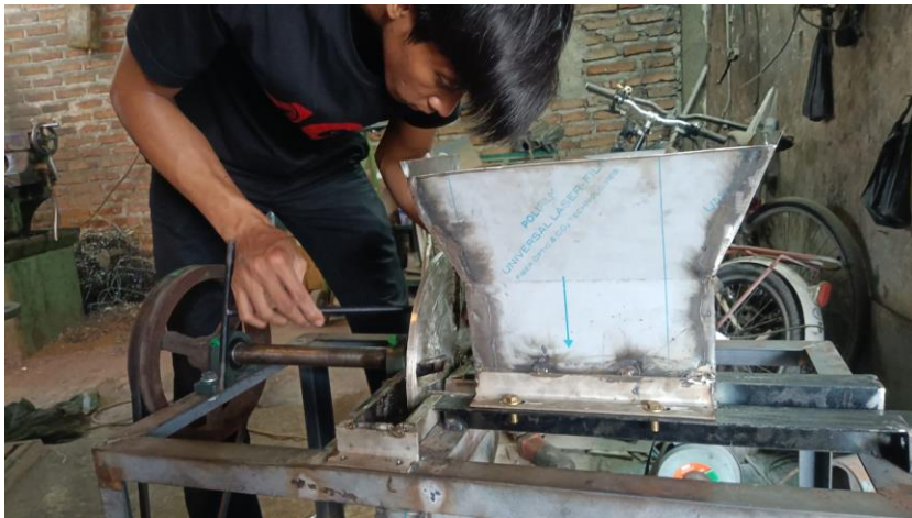
Proses Pemasangan Piringan
