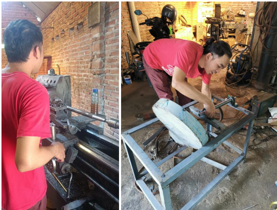
Proses pembubutan poros dan pemasangan poros
