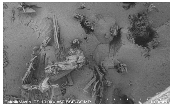
Gambar 13 Hasil Uji SEM Spesimen Tarik (C5.3) Perbesaran 50x
