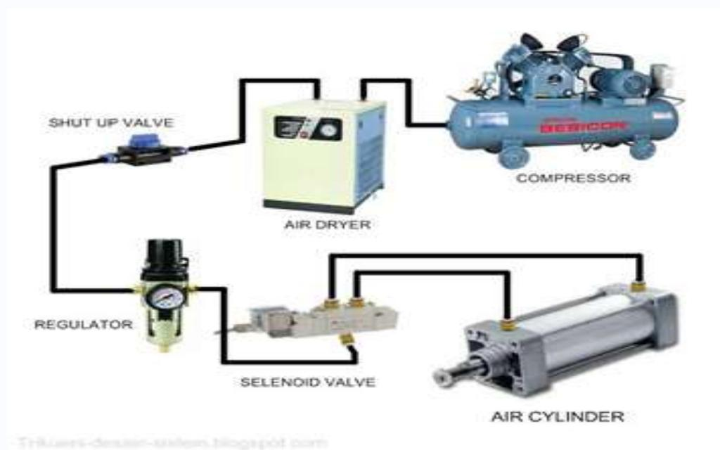
Gambar 2.26 Ilustrasi Prinsip Kerja Silinder Pneumatik<sup>5</sup>
