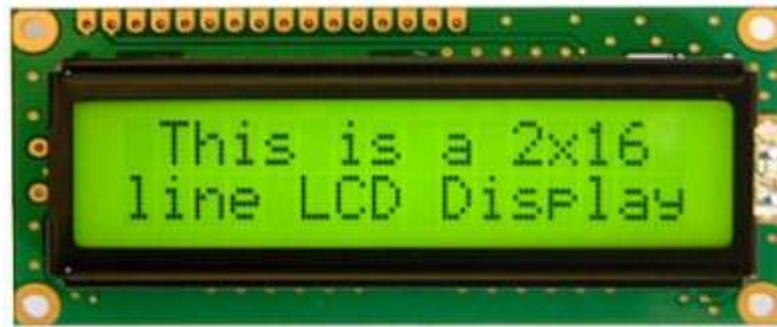
Gambar 2.14 : Bentuk Fisik LCD 2 x 16
