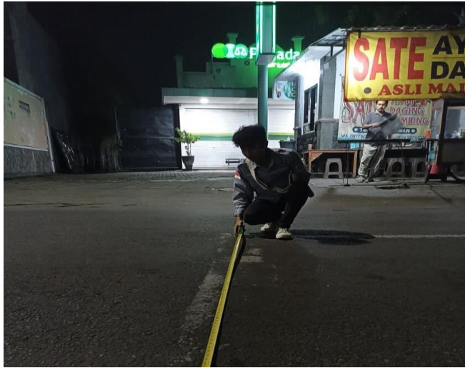
Gambar L. 3 Pengukuran lebar jalan pada Persimpangan Lakarsantri - Driyorejo (Sumber : Dokumentasi Pribadi, 2023)
