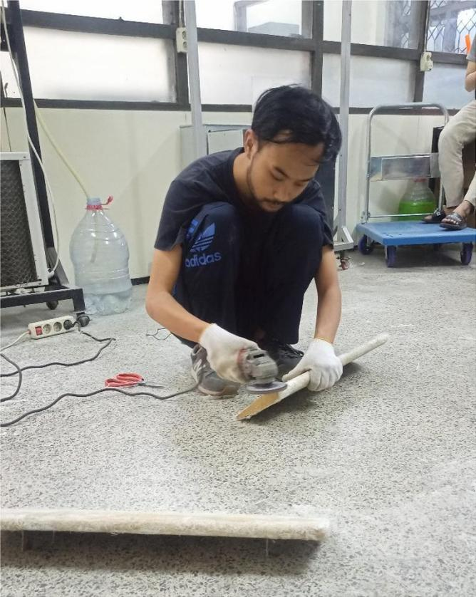
pembuatan bracket pada airfoil
