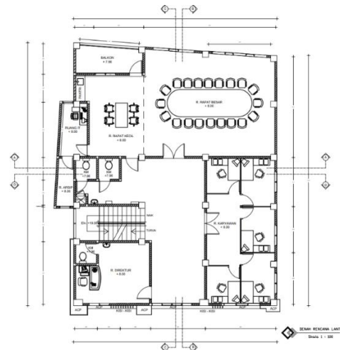
Gambar 5. Denah Tata Letak Ruang Existing Lt. 3
