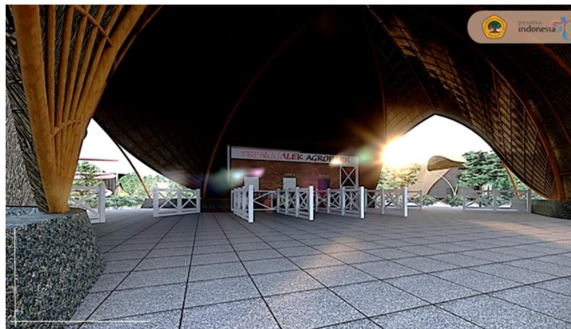
Bentuk bangunan yang terbuka, tersusun dari material alam guna menciptakan kedekatan manusia dengan alam/ lingkungan luar, serta untuk memudahkan sirkulasi pencahayaan dan penghawaan alami pada bangunan. Bangunan terbuka pada kedua sisi (utara dan selatan) untuk memecah pergerakan wisatawan.
