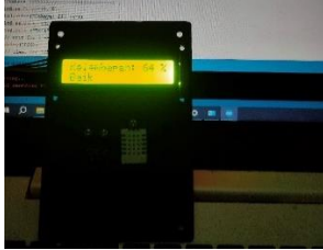
Gbr. 28 Hasil pengujian kelembapan dalam ruangan
