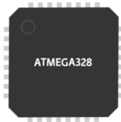
Gambar 2.3 Bentuk Fisik Mikrokontroler ATmega328
