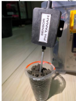
Gambar 10 Pengujian Sensor pH Tanah
