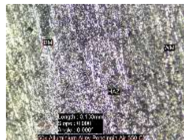
Gambar 7. Hasil mikro temperatur pemanasan 550 dengan media pendinginan air.
