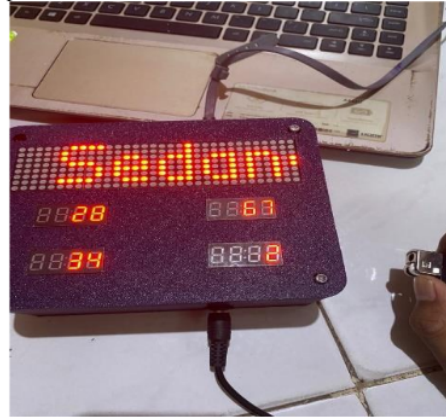
Gbr. 10 Pengujian CO dengan Korek Gas
