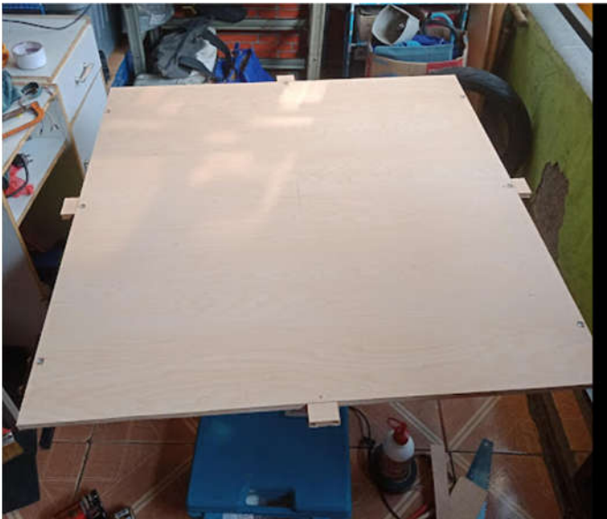
d. Pemasangan Papan timbangan dengan Frame
