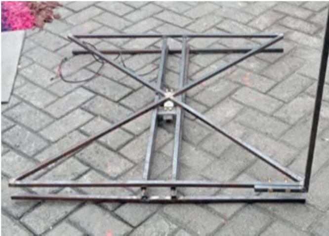
c. Frame timbangan setelah di pasang loadcell
