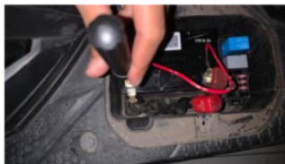
Gambar 4. 2 Pemasangan Alat di Honda Beat Street 2018
