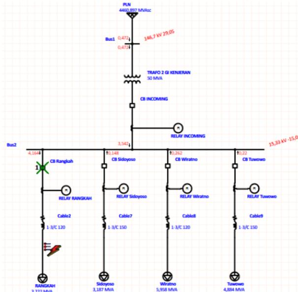
Gambar 2. Simulasi Gangguan Penyulang Rangkah
