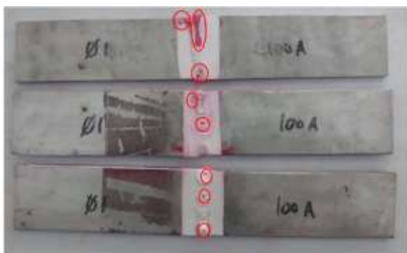
Gambar 10 hasil uji penetrasi pengelasan elektroda 1/80A
