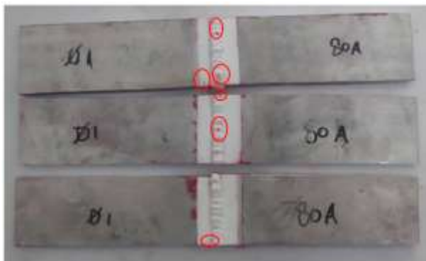
Gambar 9 hasil uji penetrasi pengelasan elektroda 0,8/120A
