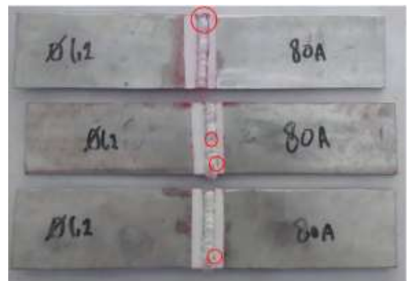
Gambar 12 hasil uji penetrasi pengelasan elektroda 1/120A
