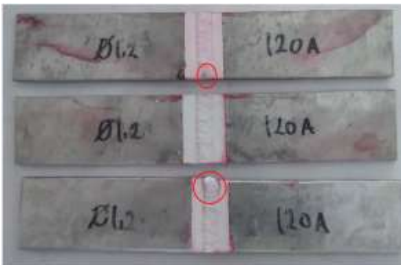
Gambar 14 hasil uji penetran pengelasan elektroda 1,2/100A
