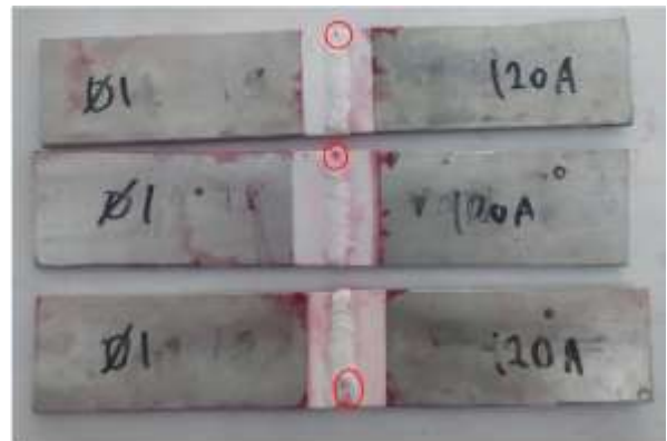
Gambar 11 hasil uji penetrasi pengelasan elektroda 1/100A
