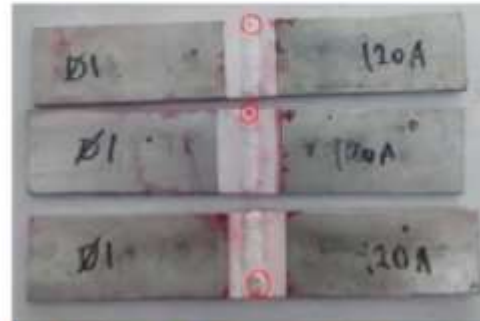
Gambar 11 hasil uji penetrasi pengelasan elektroda 1/100A
