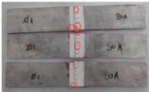
Gambar 9 hasil uji penetrasi pengelasan elektroda 0,8/120A
