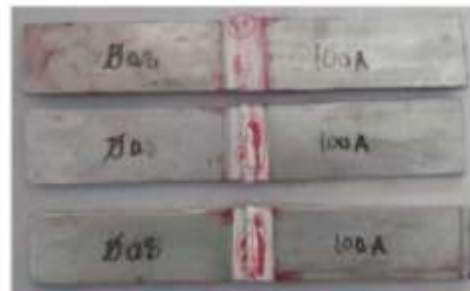
Gambar 7 hasil uji penetrant pengelasan elektroda 0.8/80A
