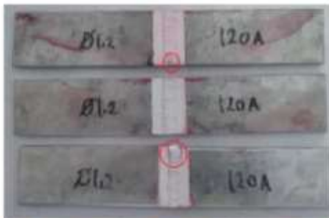
Gambar 14 hasil uji penetrasi pengelasan elektroda 1,2/100A
