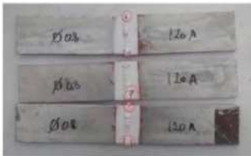
Gambar 11 hasil uji penetrasi pengelasan elektroda 1/100A
