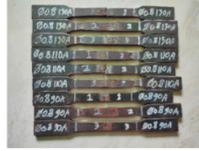
Gambar 18. Gambar Pengujian Tarik Variasi Diameter Wire Ø0,8 Arus 90A, 110A, 130A
