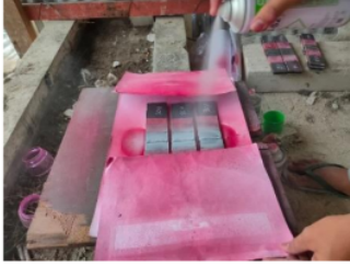
Gambar 11. Peyemprotan cairan Developer 10. Tunggu hingga 10-30 menit sebagai waktu pengamatan indikasi cacat atau discontinuity .
