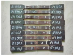
Gambar 20. Gambar Pengujian Tarik Variasi Diameter Wire Ø1 Arus 90A, 110A, 130A
