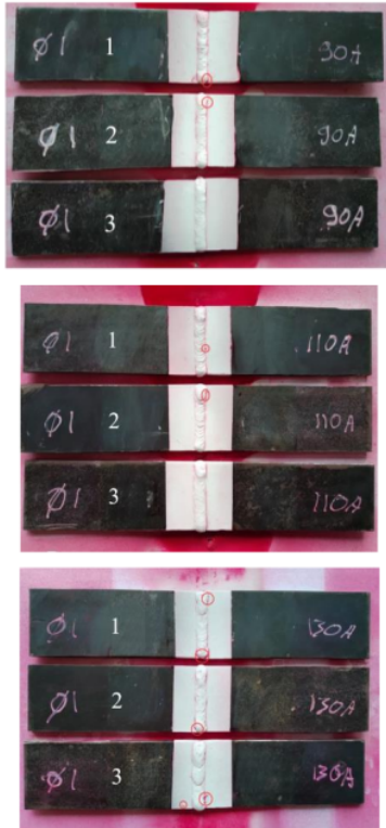
Gambar 14. Penetrasi Variasi Wire Ø1 Arus 90A, 110A, 130A
