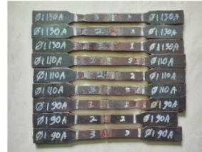
Gambar 22. Gambar Pengujian Tarik Variasi Diameter Wire Ø1,2 Arus 90A, 110A, 130A
