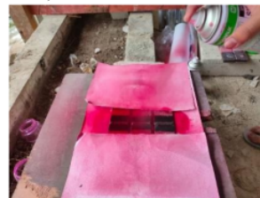
Gambar 9. Penyemprotan cairan Penetrant
