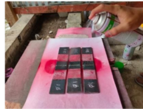
Gambar 7. Penyemprotan cairan Cleaner/Remover
