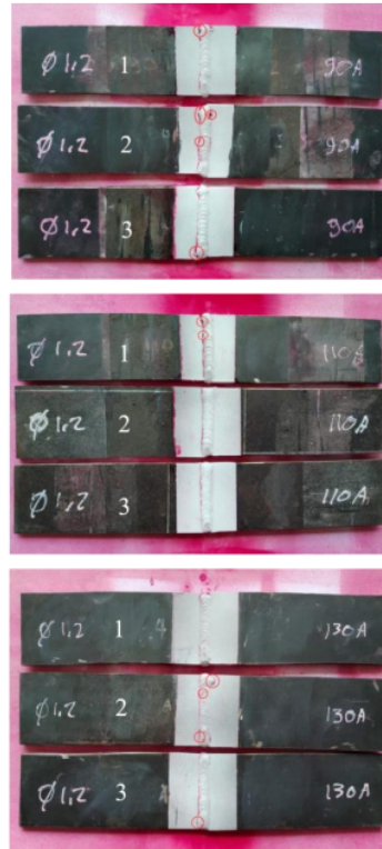
Gambar 15. Penetrasi Variasi Wire Ø1,2 Arus 90A, 110A, 130A
