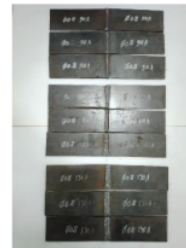
Gambar 2. Hasil Pengelasan Diameter Wire 0,8 Arus 90 A, 110 A, 130 A
