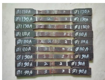
Gambar 20. Gambar Pengujian Tarik Variasi Diameter Wire Ø1 Arus 90A, 110A, 130A
