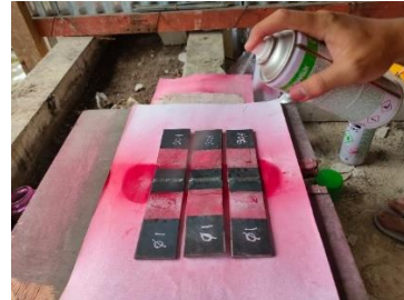
Gambar 7. Penyemprotan cairan Cleaner/Remover
