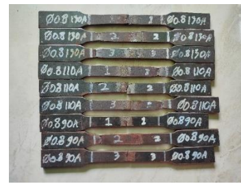
Gambar 18. Gambar Pengujian Tarik Variasi Diameter Wire Ø0,8 Arus 90A, 110A, 130A
