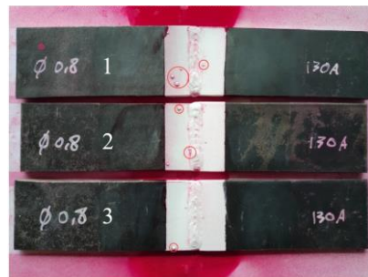
Gambar 13. Penetrasi Variasi Wire Ø0,8 Arus 90A, 110A, 130A
