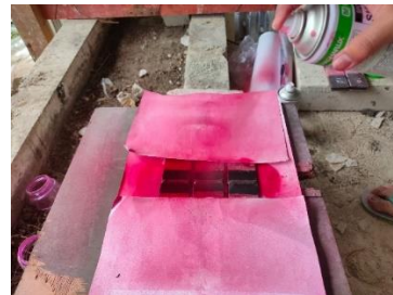
Gambar 9. Penyemprotan cairan Penetrant
