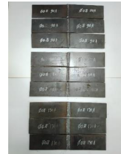
Gambar 2. Hasil Pengelasan Diameter Wire 0,8 Arus 90 A, 110 A, 130 A
