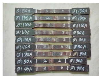
Gambar 22. Gambar Pengujian Tarik Variasi Diameter Wire Ø1,2 Arus 90A, 110A, 130A
