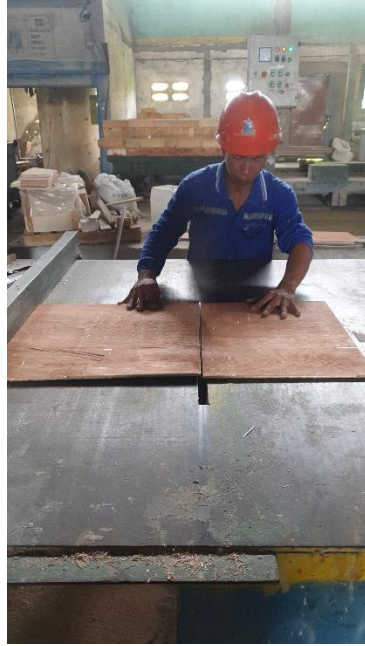
Mesin saat beroperasi memotong papan kayu tebal 15mm
