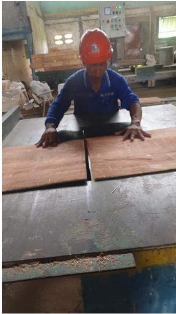
Mesin saat beroperasi memotong papan kayu tebal 15mm
