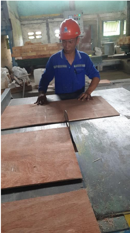
Mesin saat beroperasi memotong Papan kayu tebal 18mm
