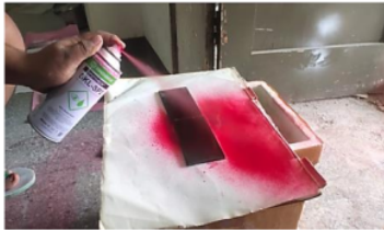
Gambar 7. Penyemprotan Red Penetrant
