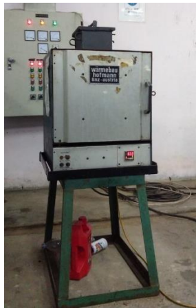
Gambar 11. Dapur Pemanas Wermebau Hofmann
