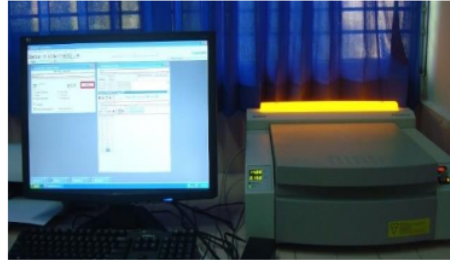
Gambar 9. Mesin uji komposisi kimia
