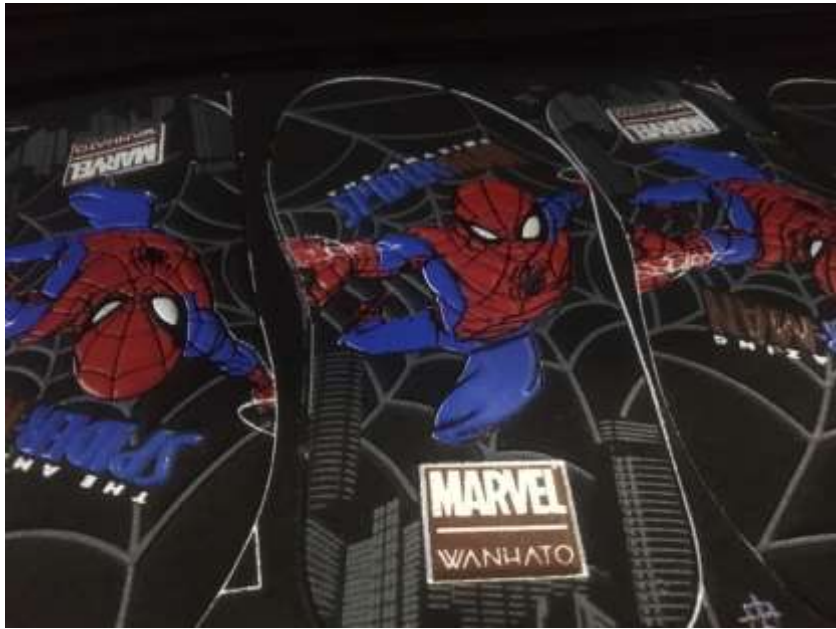
Lampiran. 3 Gambar Motif Timbul Setelah Proses Hot Embosing
