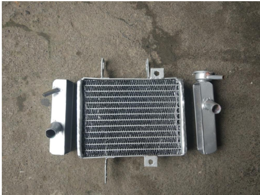
Gambar Radiator standart pipa 12 sebelum dipasang
