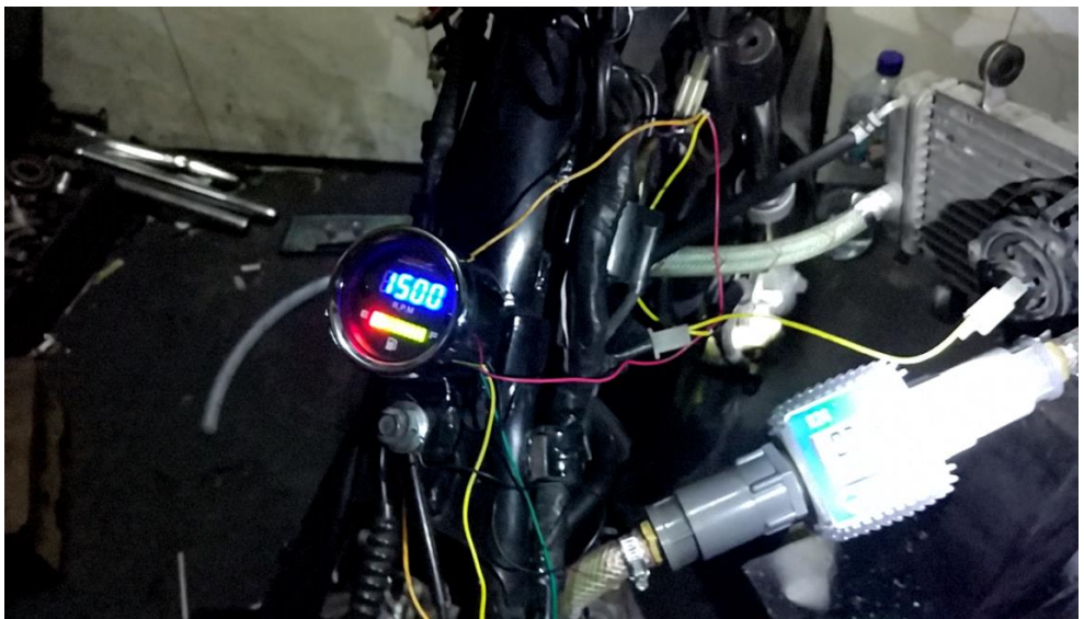
Gambar pengujian pada radiator
