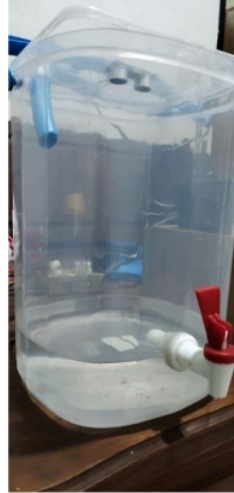
Gbr. 25S Sensor Ultrasonik Belum Terkena Air
