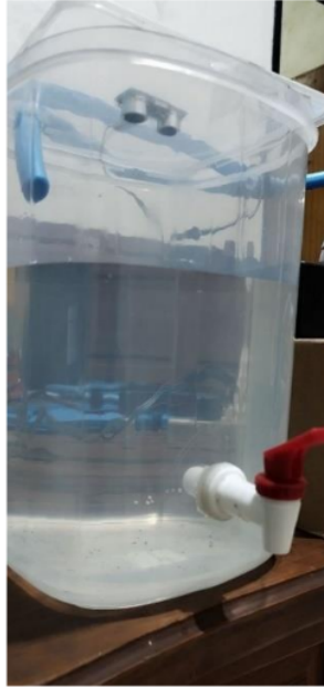
Gbr.28 Sensor Ultrasonik Sudah Terkena Air
