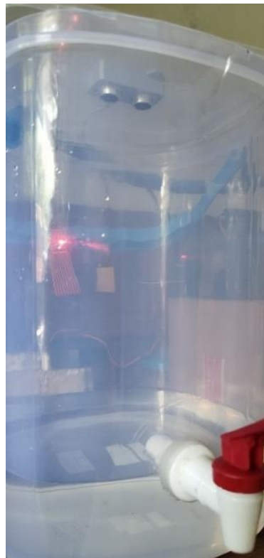
Gbr. 31 Sensor Water Level dan Sensor Ultrasonik belum terkena air
