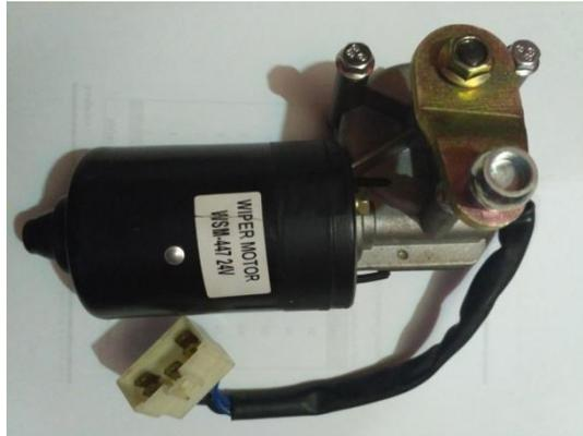
**Gambar 3.8.** Motor Penggerak Konveyor 1 Dan 2
