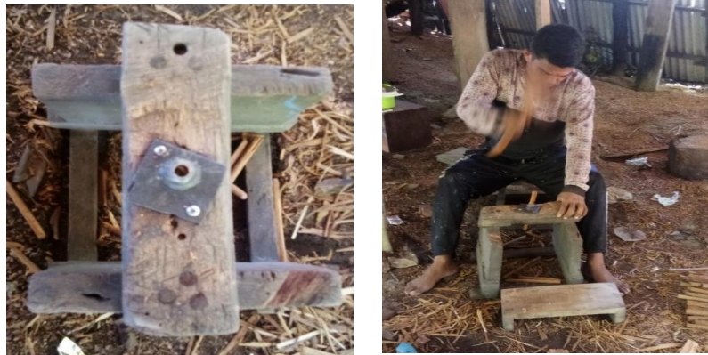
Gambar 1. Alat dan Proses Pembentukan Pasak Kayu
