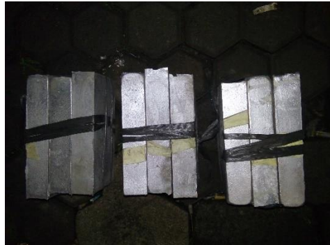
Hasil jadi setelah proses pengecoran
