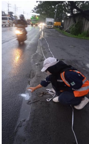
Gambar Lampiran 1. i Pengukuran Kerusakan jalan (Sumber : Dokumentasi Pribadi)
