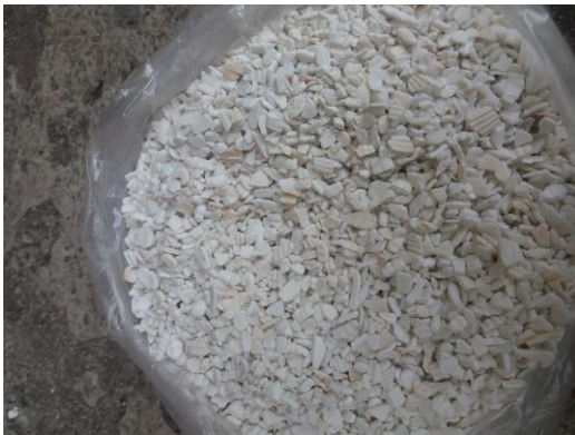
Bahan Cangkang Kerang Setelah Proses Penghancuran Dan Melalui Proses Pengayakan Ukuran 5mm
