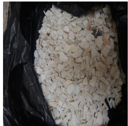
Bahan Cangkang Kerang Setelah Proses Penghancuran Dan Melalui Proses Pengayakan Ukuran 10mm
