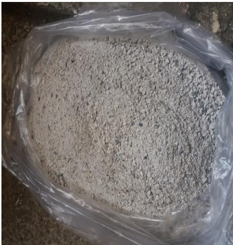
Bahan Batu Setelah Proses Penghancuran Dan Melalui Proses Pengayakan Ukuran 3mm
