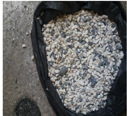
Bahan Batu Setelah Proses Penghancuran Dan Melalui Proses Pengayakan Ukuran 5mm
