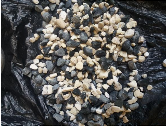
Bahan Batu Setelah Proses Penghancuran Dan Melalui Proses Pengayakan Ukuran 10mm
