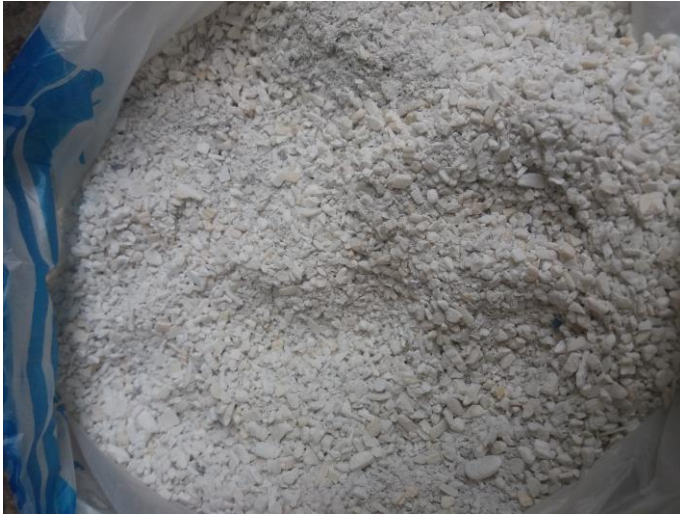
Bahan Cangkang Kerang Setelah Proses Penghancuran Dan Melalui Proses Pengayakan Ukuran 3mm
