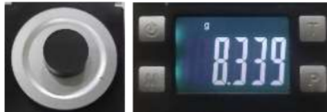
Gambar 6. Green compact dan massa spesimen setelah dikompaksi
