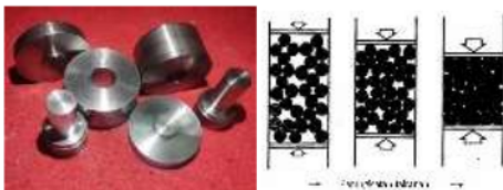
Gambar 4. Cetakan dan skema pepadatan
