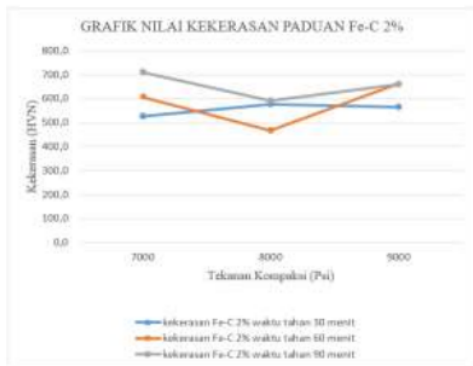
Gambar 14. Grafik keerasan dengan variasi kompaksi dan waktu tahan sintering pada paduan Fe-C 2%
