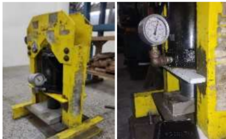
Gambar 5. Proses penekanan spesimen dengan alat hidrolik press
