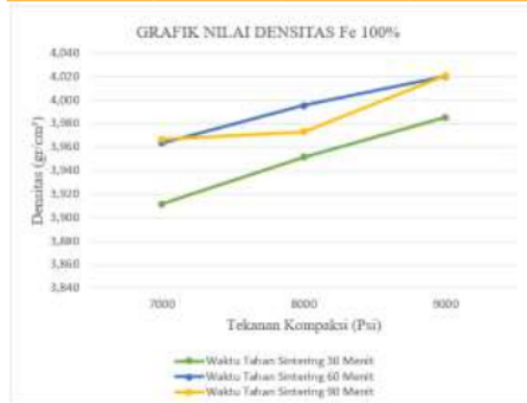
Gambar 13. Grafik densitas dengan variasi kompaksi dan waktu tahan sintering Fe 100%
