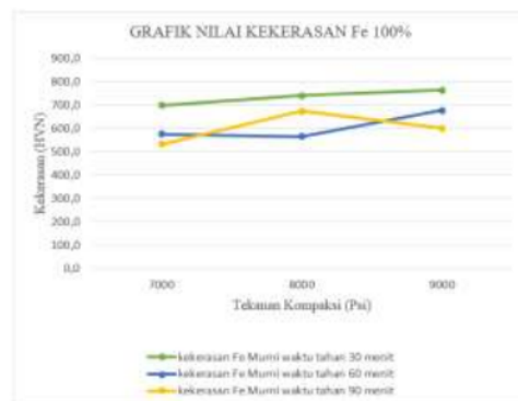
Gambar 15. Grafik keerasan dengan variasi kompaksi dan waktu tahan sintering Fe 100%
