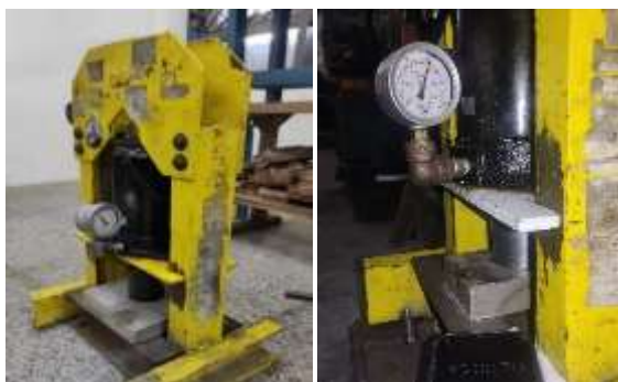
Gambar 5. Proses penekanan spesimen dengan alat hidrolik press
