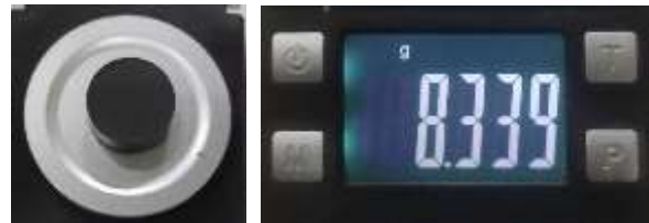
Gambar 6. Green compact dan massa spesimen setelah dikompaksi
