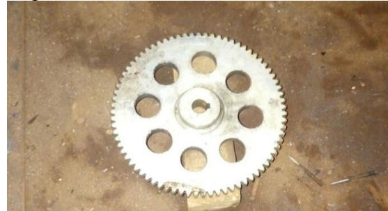
Gambar 6. Roda gigi pada kincir
