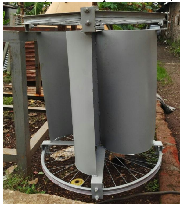
Gambar 3. Plat sudu yang sudah di Roll
