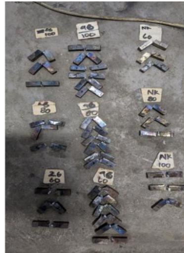
Gambar 9. Hasil pengujian ketangguhan impact charpy
