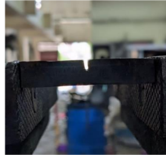
Gambar 6. Pembuatan spesimen uji ketangguhan berdasarkan ASTM E23 dengan bentuk takik U
