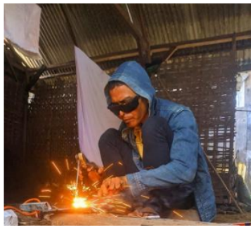
Gambar 5. Proses pembuatan spesimen dengan pengelasan
