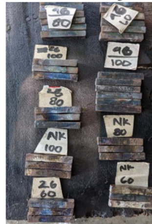
Gambar 7. Spesimen Pengujian Ketangguhan Impact
