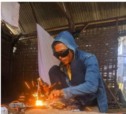
Gambar 5. Proses pembuatan spesimen dengan pengelasan
