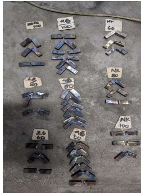
Gambar 9. Hasil pengujian ketangguhan impact charpy
