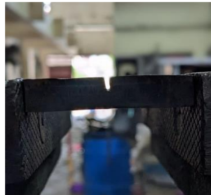
Gambar 6. Pembuatan spesimen uji ketangguhan berdasarkan ASTM E23 dengan bentuk takik U
