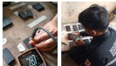
Gambar 3. 10 Pengukuran Ketebalan Cat Kering
