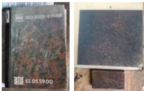
Gambar 3. 4 Persiapan Permukaan Baja Sebelum Blasting
