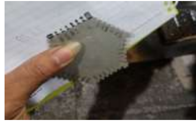
Gambar 3. 9 Pengukuran Ketebalan Cat Basah
