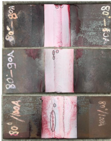
Gambar 6 Spesimen uji penetrant (kampuh V 80° arus 80A, 90A, 100A)
