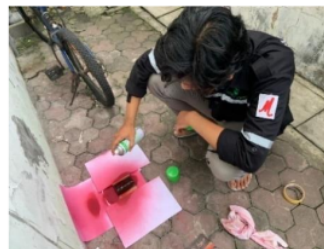
Gambar 2 penyemprotan cairan red penetrant
