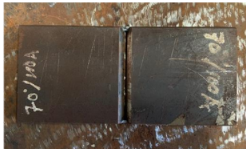
Gambar 1 material yang telah diberi tack weld
