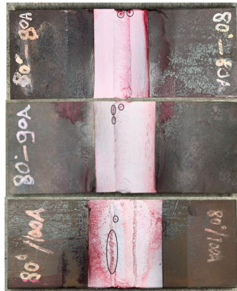
Gambar 6 Spesimen uji penetrant (kampuh V 80° arus 80A, 90A, 100A)
