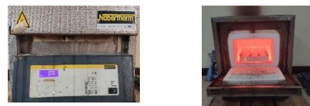
Gambar 4. Proses Penuaan Spesimen
