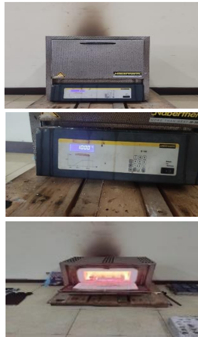
Gambar 3. Proses sintering spesimen
