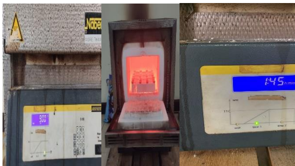
Gambar 4. Proses Penuaan Spesimen
