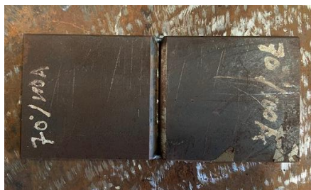
Gambar 1 material yang telah diberi tack weld
