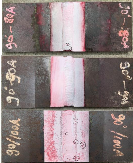
Gambar 7 Spesimen uji penetrant (kampuh V 90° arus 80A, 90A, 100A)
