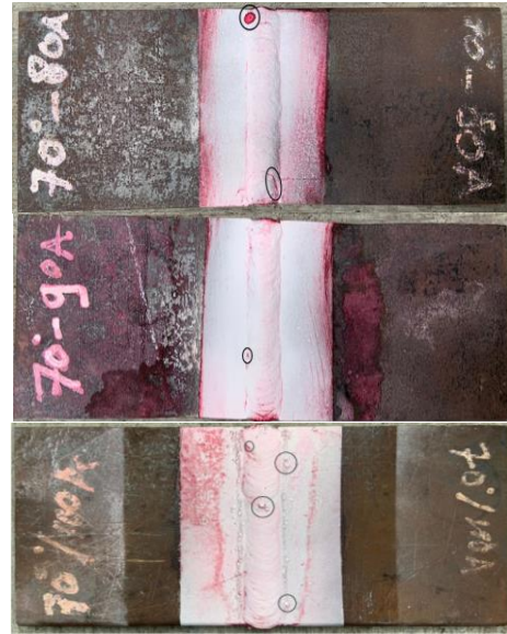
Gambar 5 Spesimen uji penetrant (kampuh V 70° arus 80A, 90A, 100A)
