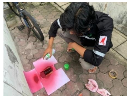
Gambar 2 penyemprotan cairan red penetrant
