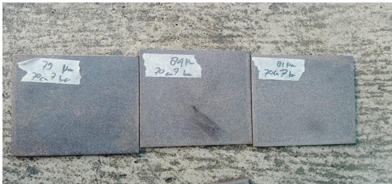
Hasil proses sandblasting dengan tekanan 7 bar dan jarak 70 cm pada baja ST 40
