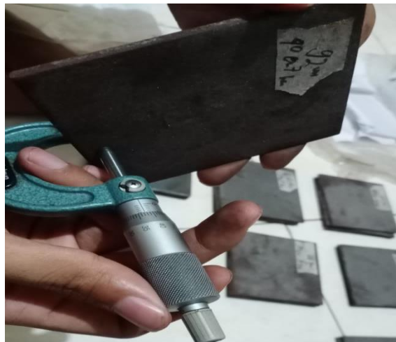
Ketebalan spesimen variasi 7 bar 40 cm baja ST 40
