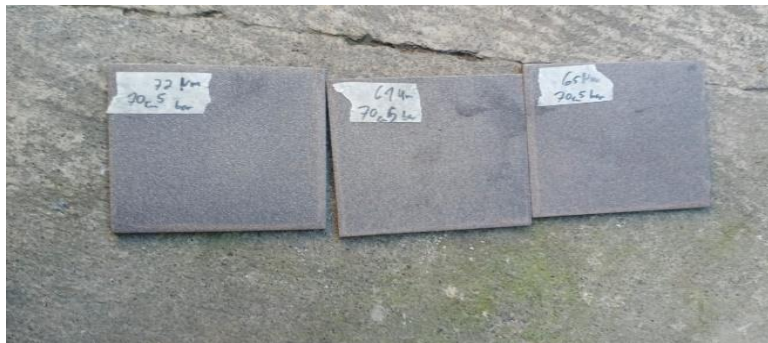
Hasil proses sandblasting dengan tekanan 5 bar dan jarak 70 cm pada baja ST 40
