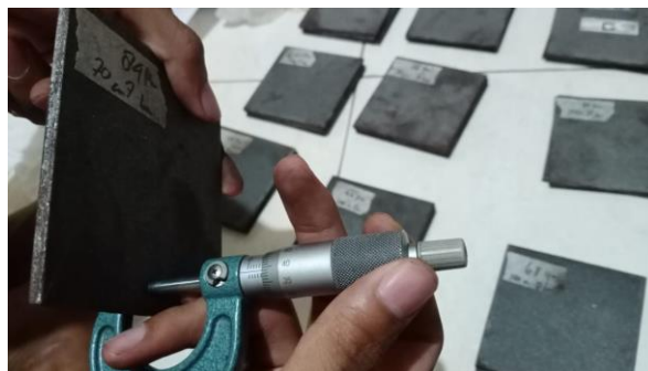
Ketebalan spesimen variasi 7 bar 40 cm baja ST 40
