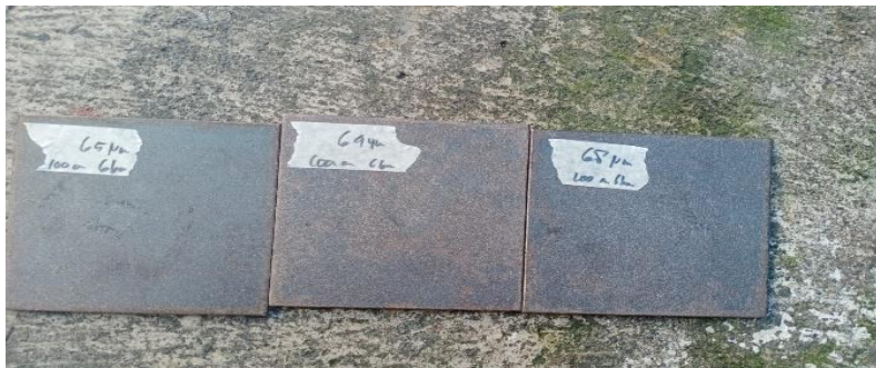
Hasil proses sandblasting dengan tekanan 6 bar dan jarak 100 cm pada baja ST40
