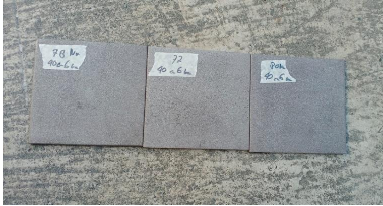
Hasil proses sandblasting dengan tekanan 6 bar dan jarak 40 cm pada baja ST 40
