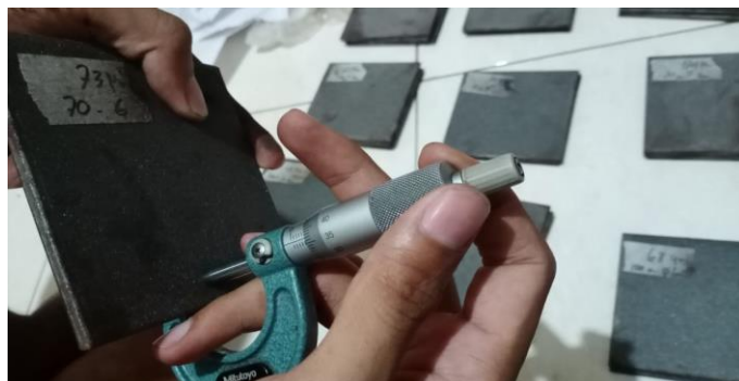
Ketebalan spesimen variasi 6 bar 70 cm baja ST 40
