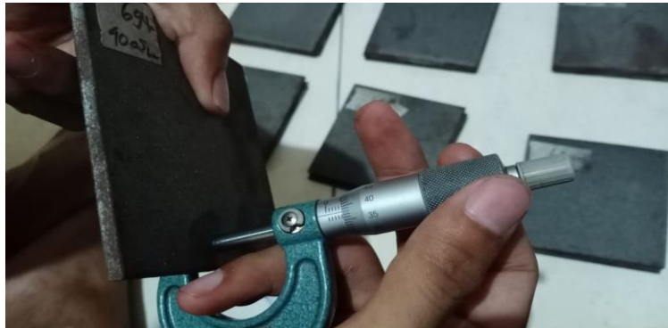
Ketebalan spesimen variasi 5 bar 40 cm baja ST 40
