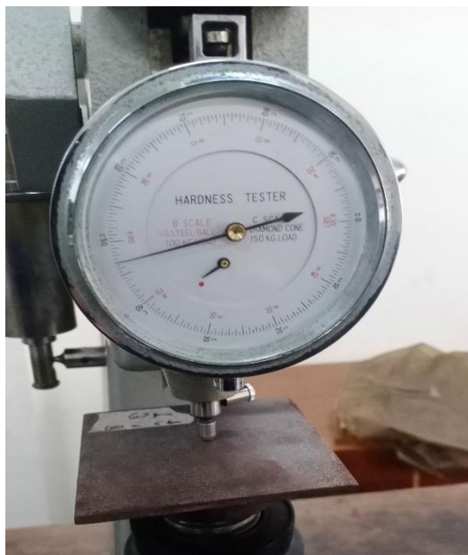
Gambar 4.28 Kekerasan spesimen di variasi 5 bar 100 cm pada baja ST 40
