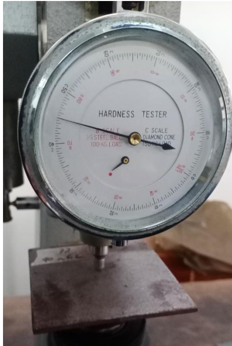
Kekerasan spesimen di variasi 6 bar 40 cm pada baja ST 40
