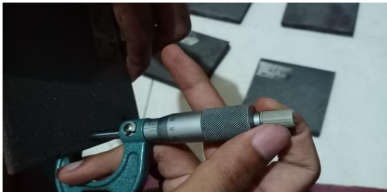
Ketebalan spesimen variasi 5 bar 70 cm baja ST 40
