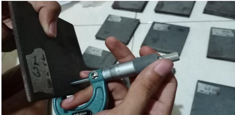
Ketebalan spesimen variasi 5 bar 100 cm baja ST 40
