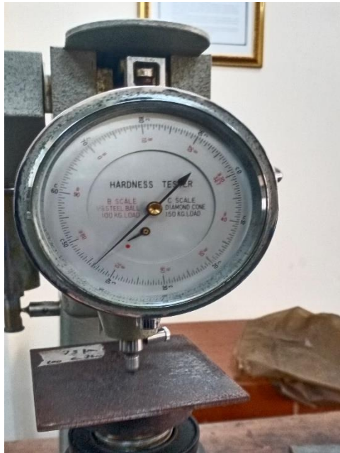
Kekerasan spesimen di variasi 7 bar 100 cm pada baja ST 40
