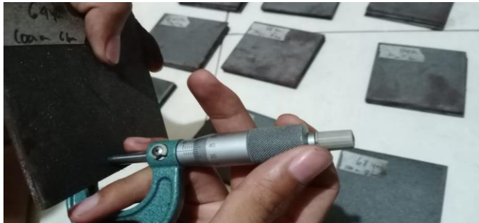
Ketebalan spesimen variasi 6 bar 100 cm baja ST 40
