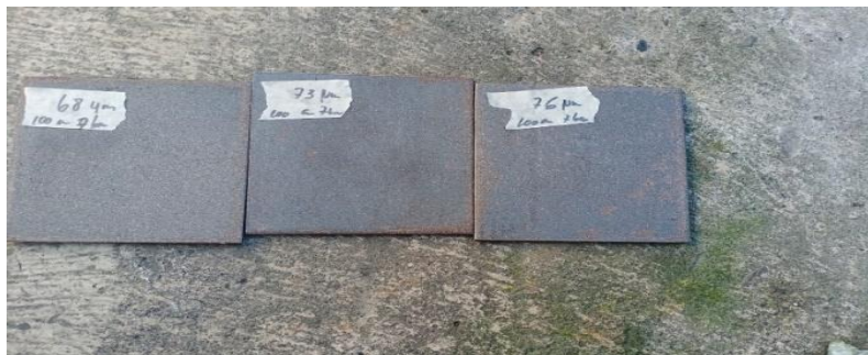
Hasil proses sandblasting dengan tekanan 7 bar dan jarak 100 cm pada baja ST 40
