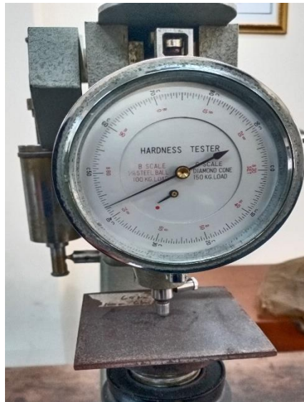
Kekerasan spesimen di variasi 6 bar 100 cm pada baja ST 40
