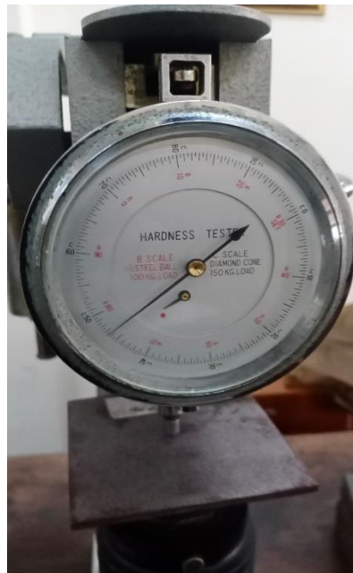
Kekerasan spesimen di variasi 7 bar 40 cm pada baja ST 40
