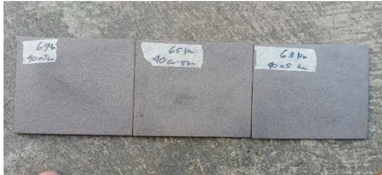
Hasil proses sandblasting dengan tekanan 5 bar dan jarak 40 cm pada baja ST 40
