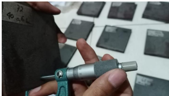
Ketebalan spesimen variasi 6 bar 40 cm baja ST 40
