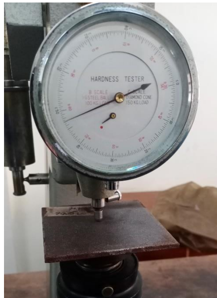
Kekerasan spesimen di variasi 6 bar 70 cm pada baja ST 40
