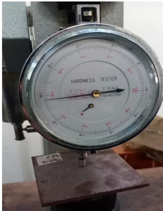
Gambar 4.26 Kekerasan spesimen di variasi 5 bar 40 cm pada baja ST 40
