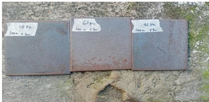
Hasil proses sandblasting dengan tekanan 5 bar dan jarak 100 cm pada baja ST 40
