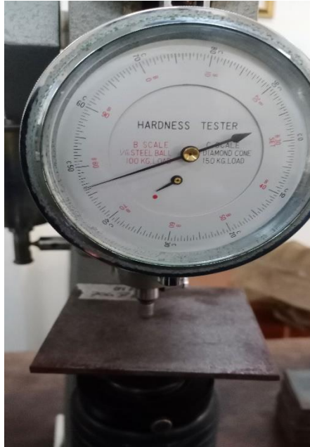
Kekerasan spesimen di variasi 7 bar 70 cm pada baja ST 40
