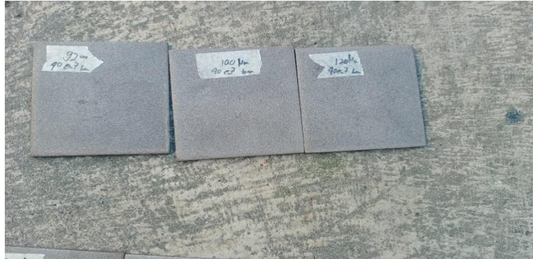
Hasil proses sandblasting dengan tekanan 7 bar dan jarak 40 cm pada baja ST 40
