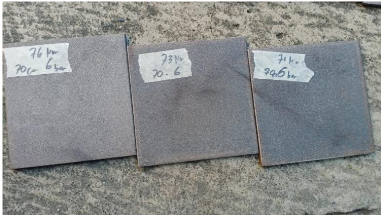
Hasil proses sandblasting dengan tekanan 6 bar dan jarak 70 cm pada baja ST 40
