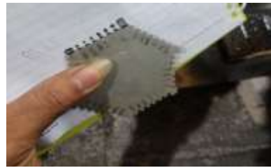
Gambar 3. 9 Pengukuran Ketebalan Cat Basah
