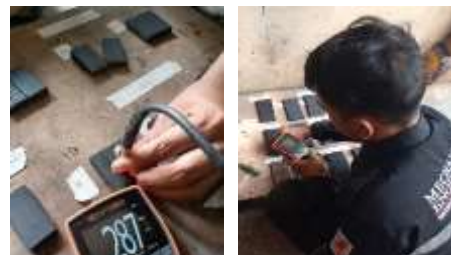
Gambar 3. 10 Pengukuran Ketebalan Cat Kering
