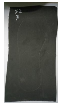
Gambar hasil pengujian pada pneumatik 32 dengan tekanan 7 bar
